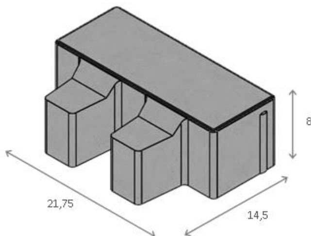
Il s'agit d'un pavé drainant avec ouvertures de drainage et écarteurs. Il présente un **chanfrein 2/2 mm** sur ses arrêtes.
