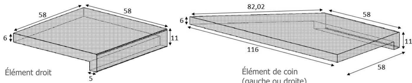
Les margelles en béton Interblocs sont texturées et anti-dérapantes sur la surface supérieure.
